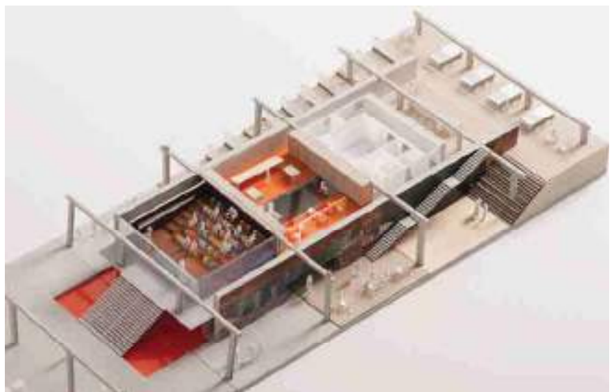
A korábbi épületből csak a vasbeton pillér-gerenda rendszer és a főfalak maradtak meg
