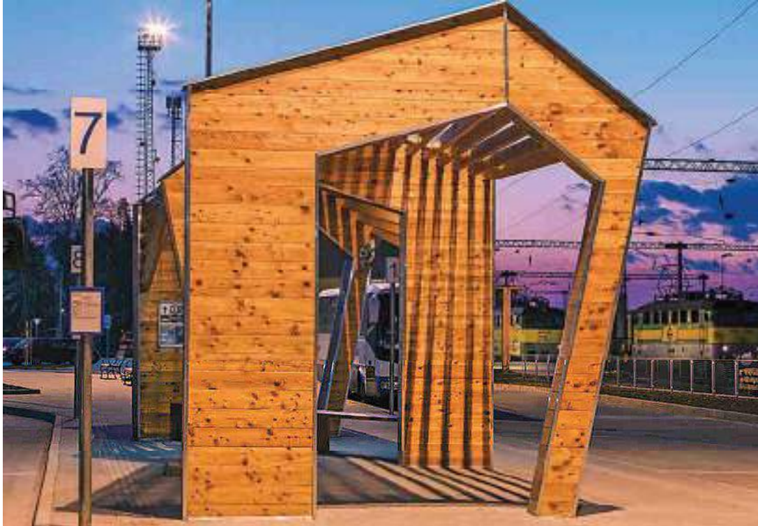
A ragasztott fa tartószerkezetek a ház archetipikus keresztmetszeteinek állásonként változó geometriájú, kortárs átíratái
