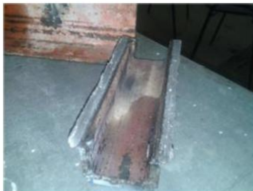
A nyíróvizsgálat során bekövetkezett törés, törési felület
